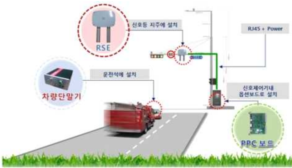
<<서울시 강북구 스마트 긴급차량 우선 신호시스템 예시>>
