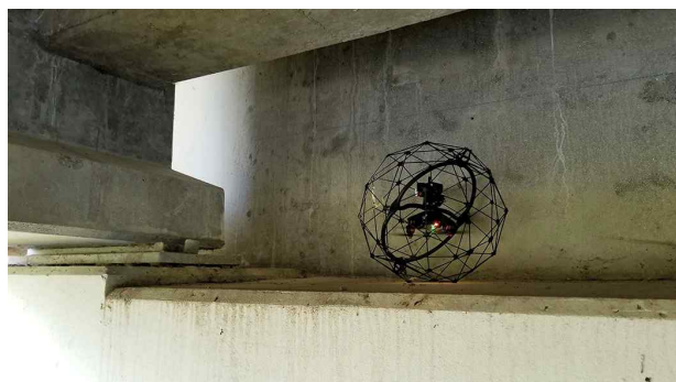
<< Elios2 접근취약시설물 점검 로봇 >>
