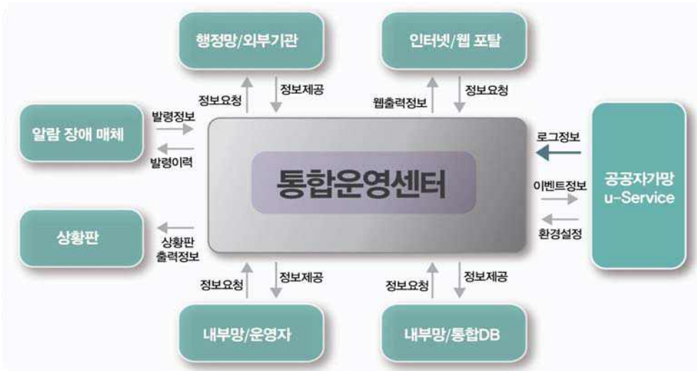
[그림 4-2-14] 통합운영센터 정보시스템의 기능/지역별 상호간 데이터 흐름
