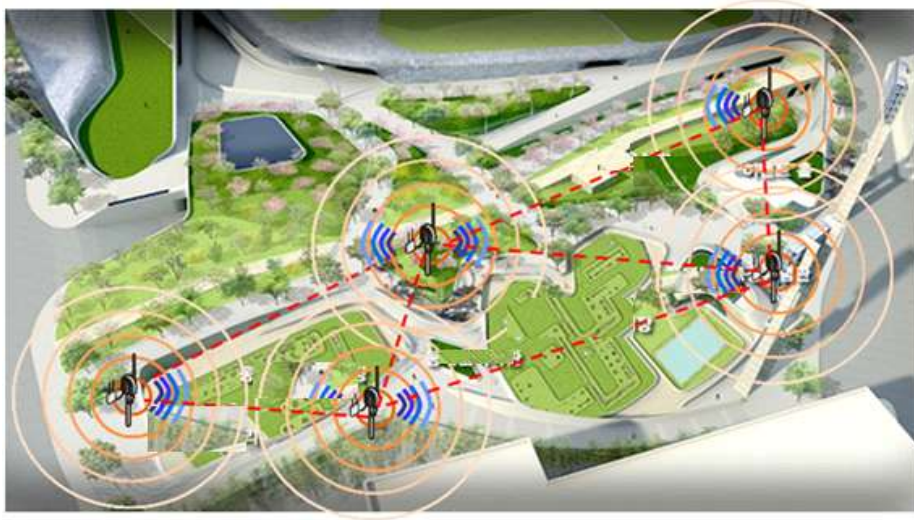
[그림 4-2-7] 공원 무선망 구성도 예시
