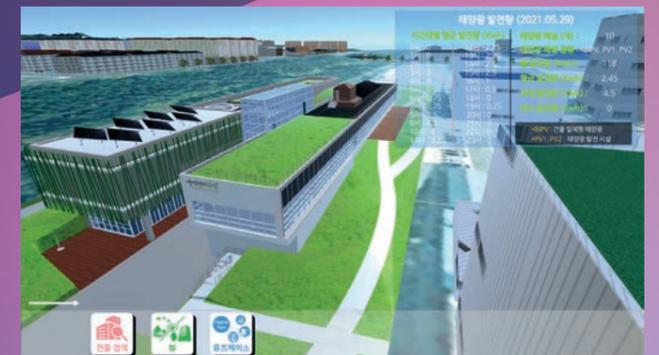
시흥시 서울대학교 시흥캠퍼스와 시흥 에코센터에 에너지 분야 디지털 트윈을 적용한 예로서, BIM(건물정보모델) 기반 에너지 데이터 실시간 시각화 및 인공지능 학습·추론 서비스와 건축물 에너지 시뮬레이션 서비스 실증 진행
