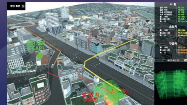
대구광역시 서구 비산동(인동촌) 지역에 재난·안전 분야 디지털 트윈을 적용한 예로서, 화재 시 건물 재실자 최단대피경로 및 긴급구난 차량 최단경로 도출 서비스와 3D 지형지물 객체 기반 시뮬레이션을 통한 침수 예상지역 시각화 서비스 실증 진행
