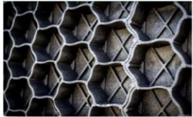
오래된 풍력 터빈 블레이드 및 재활용 플라스틱으로 된 소음장벽
