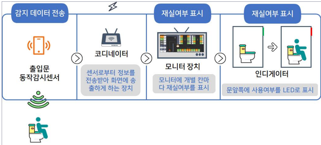
[ 그림 31 ] IoT 스마트 화장실 서비스 구성도
