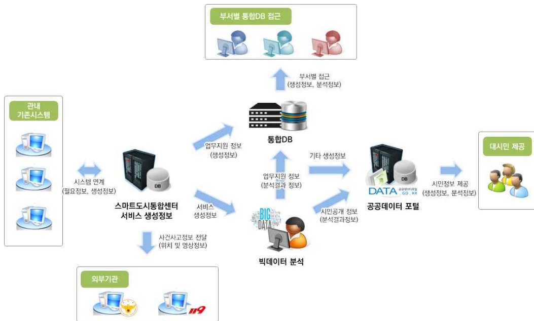
〈그림 II-68〉 스마트도시 서비스 정보 제공 및 시스템 연계를 위한 종합구상(안)
