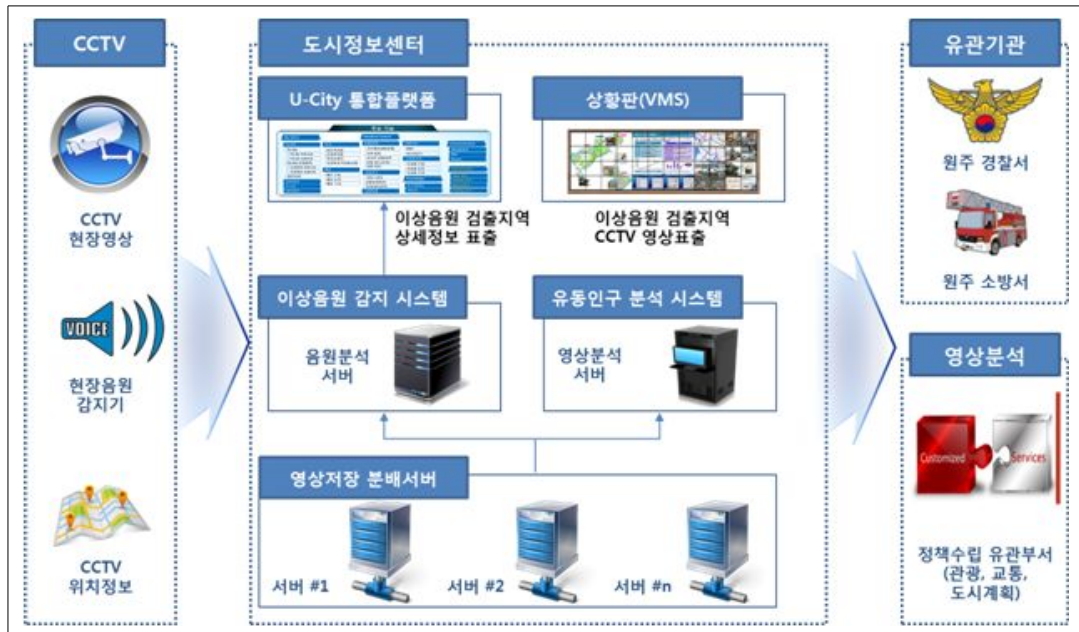
[그림 IV-6] 지능형 CCTV 시스템 개념도
