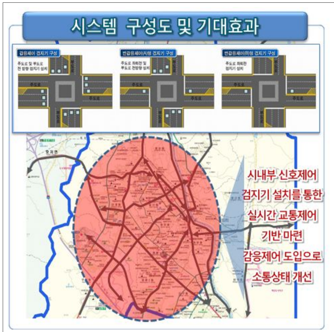
[그림 II-81] 교통신호제어시스템 확대(실시간 신호제어) 시스템 구성도 및 기대효과
