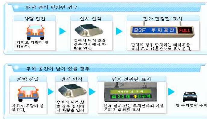
[그림 IV-23] 지능형주차유도 서비스 구성도(예시)
