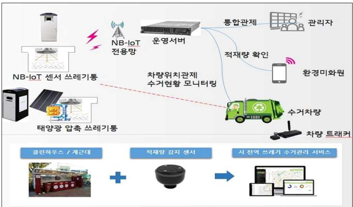
[그림 IV-23] 쓰레기 통합수거관리 시스템 구축 개념도
