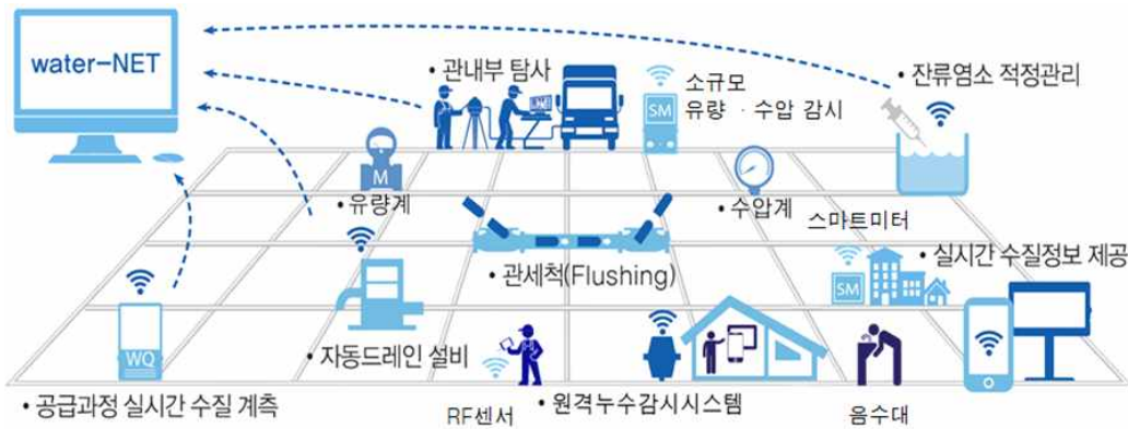
[그림 IV-25] 수도원격검침, 수질모니터링 시스템 구축 개념도
