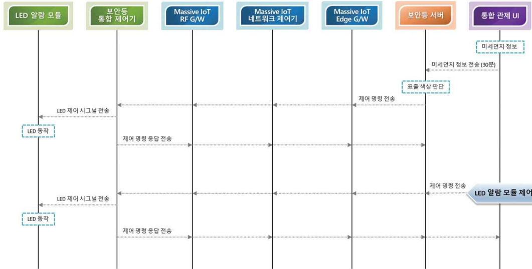
〈그림 2-6〉 미세먼지 데이터 연계를 통한 보안등 상태 LED 표시 시나리오 Flow
