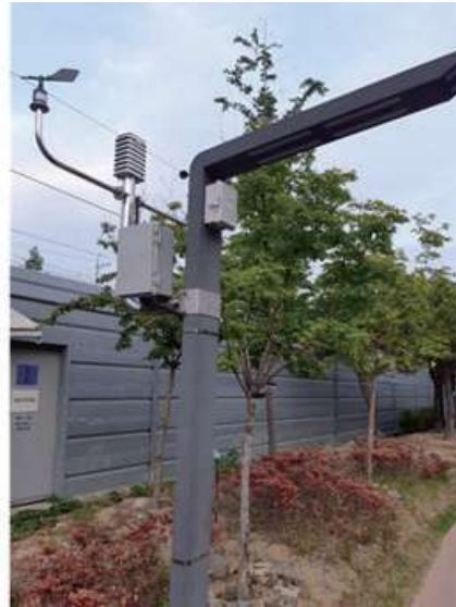
〈그림 2-18〉 환경 센서(좌)와 폭염 저감 장치 제어기기 설치(우)
