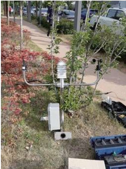
〈그림 2-18〉 환경 센서(좌)와 폭염 저감 장치 제어기기 설치(우)
