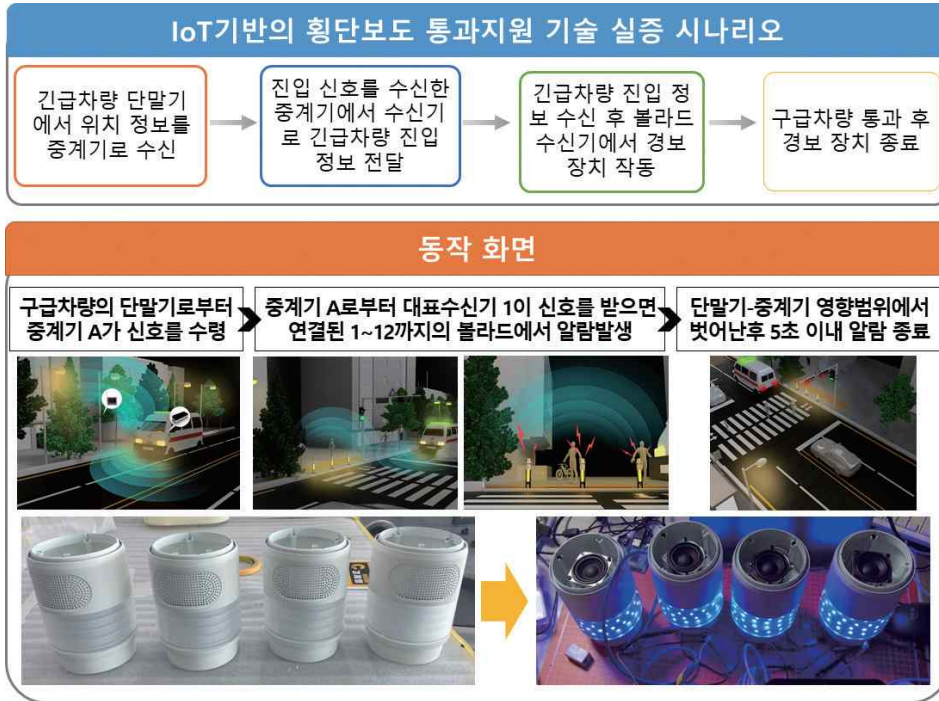
〈그림 3-4〉 IoT기반 횡단보도 통과지원 기술 실증 방법
