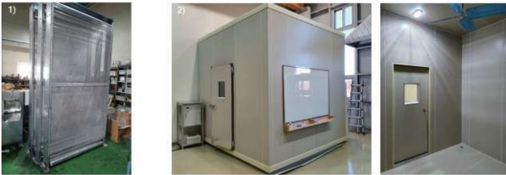
〈그림 5-5〉 프로토타입 제진벽과 미세먼지 저감 실험용 챔버
