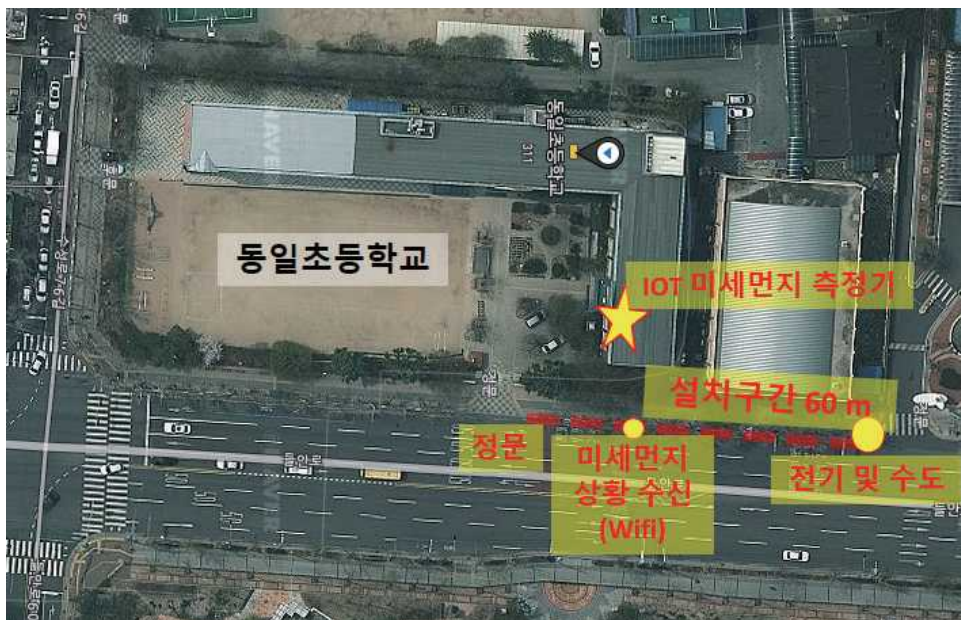
〈그림 3-2〉 도로 날림먼지 포집 시스템 실증 규모
