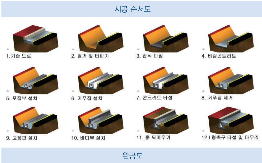
〈표 2-4〉 도로 날림먼지 자동포집 시스템의 시공 순서도와 완공도
