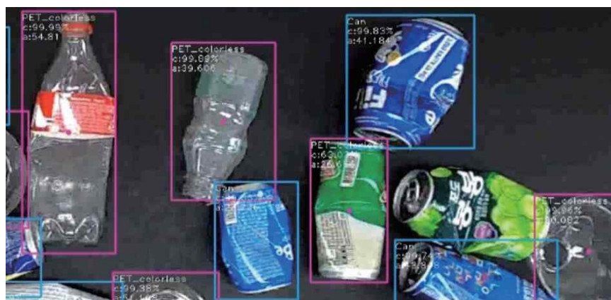
〈그림 2-5〉 각 폐기물 종류, 확률, 크기 등을 출력하는 CNN기반 폐기물 종류 구별 PoC
