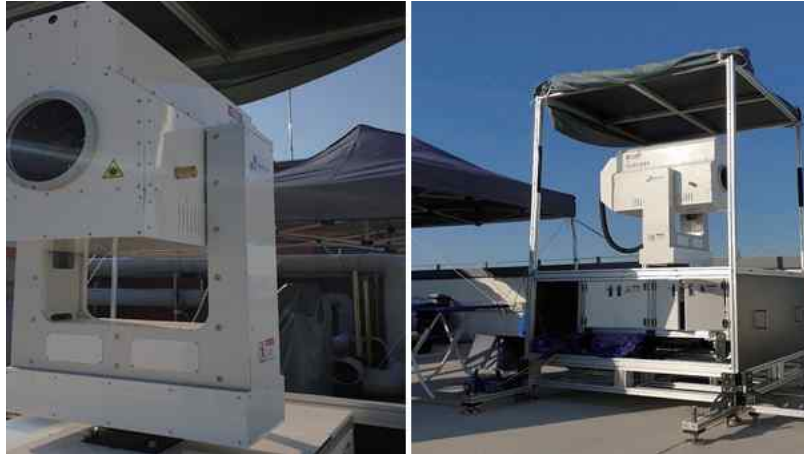
〈그림 3-1〉 한국산업기술대학교 제2캠퍼스에 설치된 자체 개발한 스캐닝 라이다 시스템
