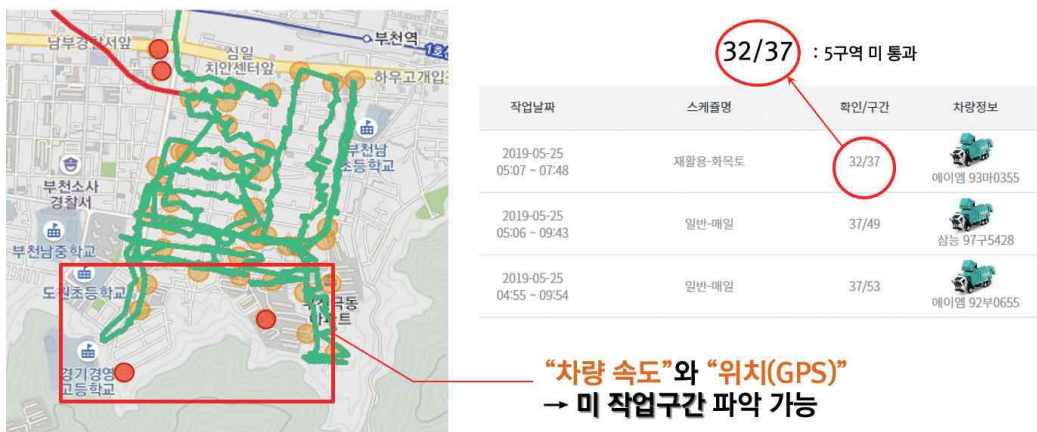
〈그림 3-5〉 지오펜스(GeoFence) 및 차량 속도를 통한 작업구간 조회
