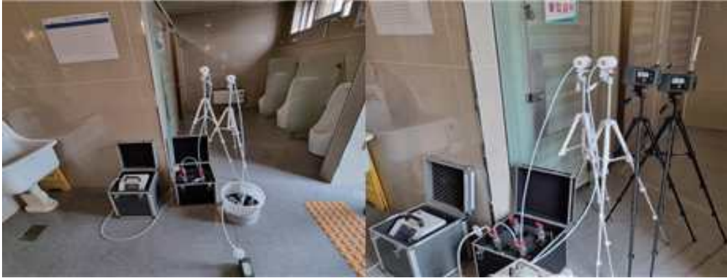
〈그림 3-3〉 악취 시료채취 및 측정(갯골생태공원 야외화장실)
