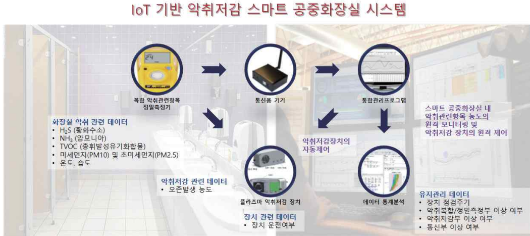
〈그림 3-5〉 IoT 기반 악취저감 스마트 공중화장실 시스템의 데이터 흐름 개요
