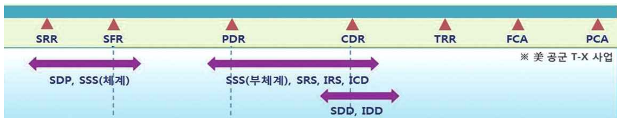
[그림 11] 기술검토회 및 대상산출물 (출처: SE기반 기술검토회의 가이드북, 2017, 방위사업청)
