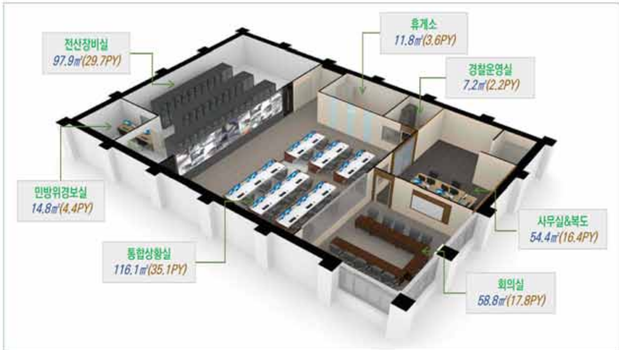
[그림 II-2-27] 진주시 도시관제센터 평면도(361㎡-109평)
