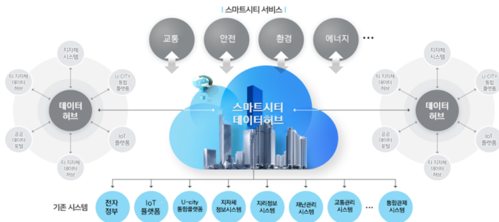
[그림 2-2-8] 스마트시티 데이터 허브 기존 시스템 연계방안
