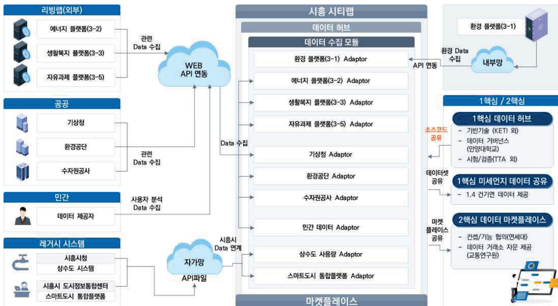
[그림 IV-178] 시흥시 데이터 수집 시스템 구성도
