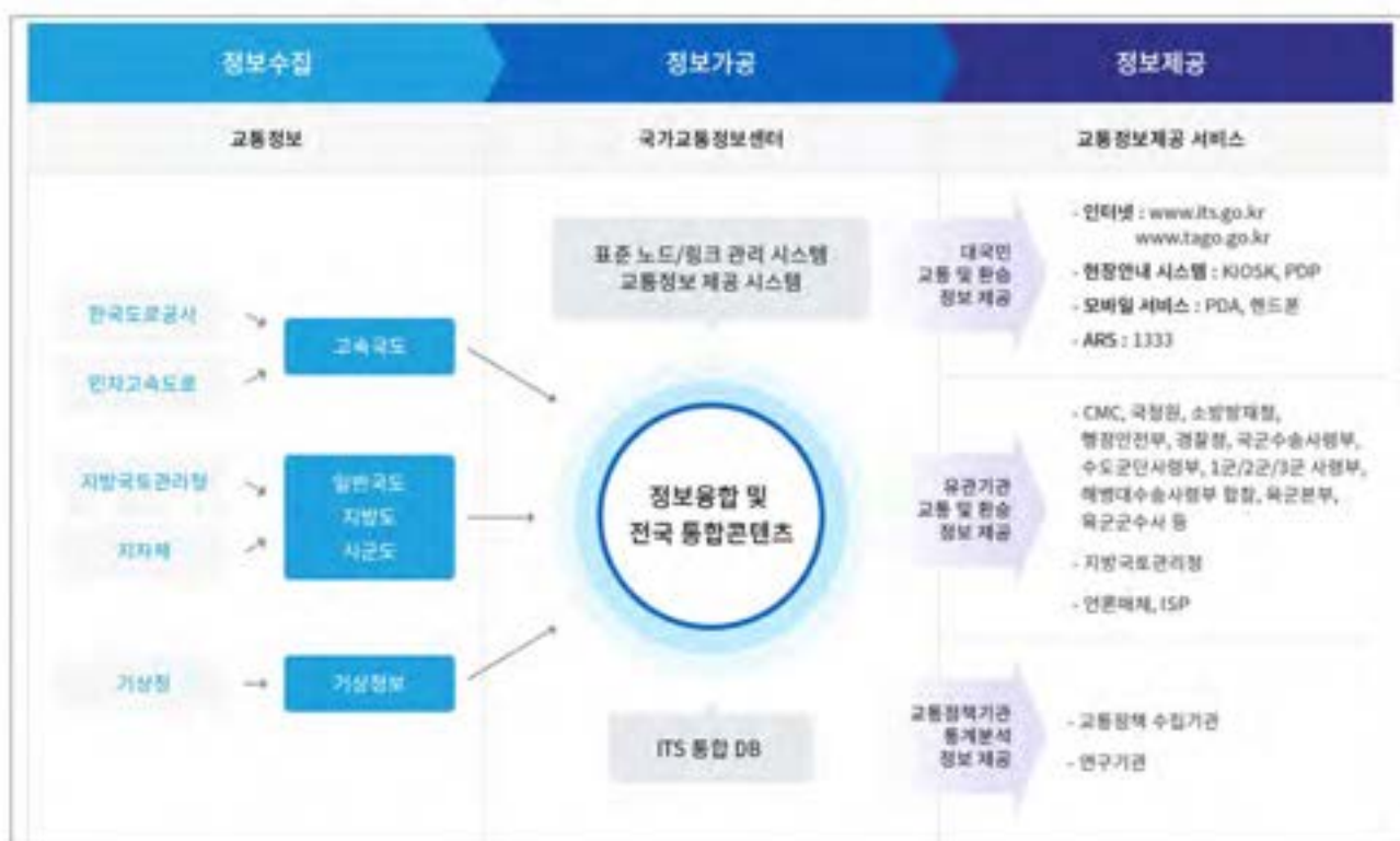
[그림 II-3-3] 국가교통정보센터의 실시간 교통정보 연계 과정
