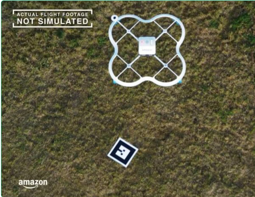
Figure 6 아마존 드론 배송 테스트 주행에서 식별자(마커)를 향해 하강하는 모습
