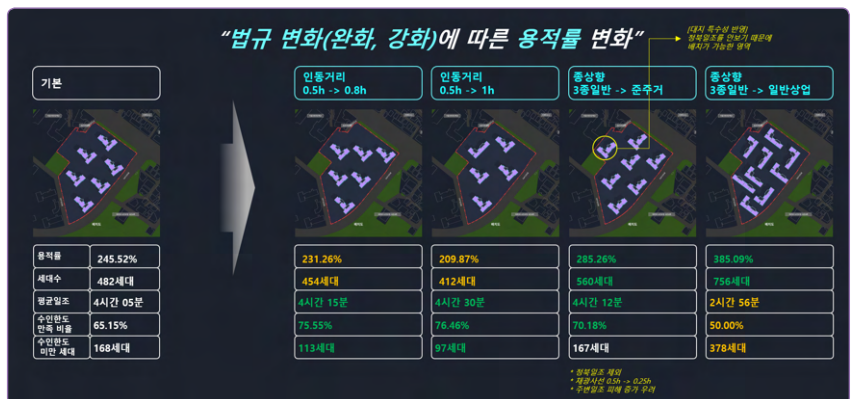
Figure 5 인동거리, 용도지역 기준값의 변화에 따른 인공지능 설계 결과물(BUILDIT)
