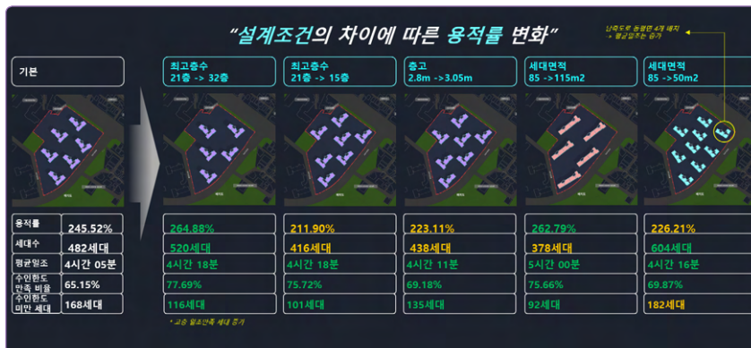
Figure 6 최고 층수, 층고, 세대 타입 기준 변화에 따른 인공지능 설계 결과물(BUILDIT)
