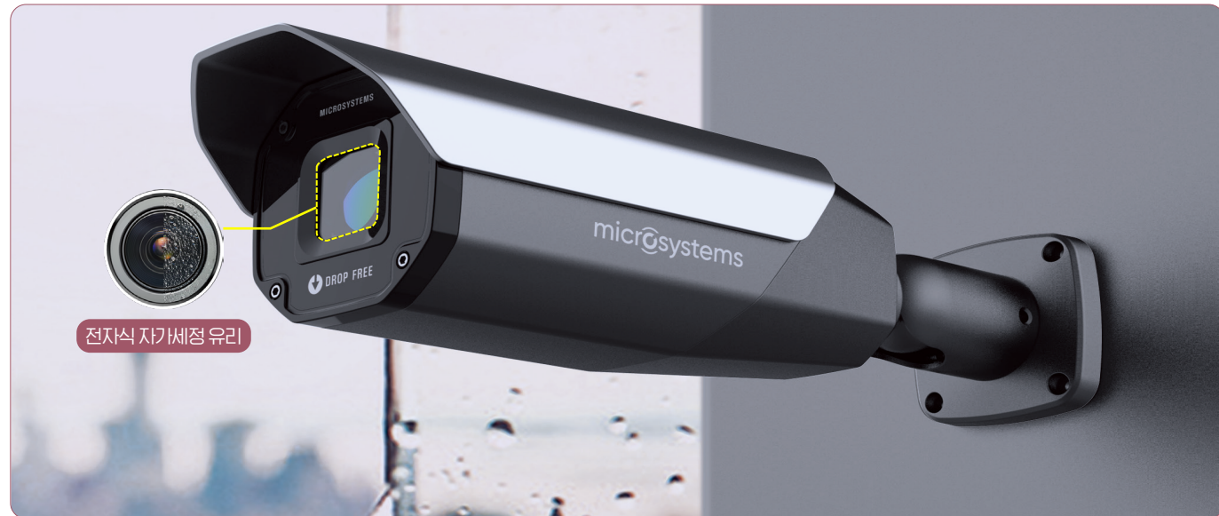
▲ 전자식 자가세정 유리(Drop Free Glass)를 적용한 CCTV 장치가 오염물을 자동 감지하여 세정하고 있다.
