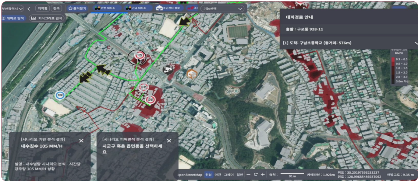
▲지방자치단체 관계자가 하천 범람에 따른 침수 예상 지역을 분석하고 대피 경로를 시뮬레이션하고 있다
