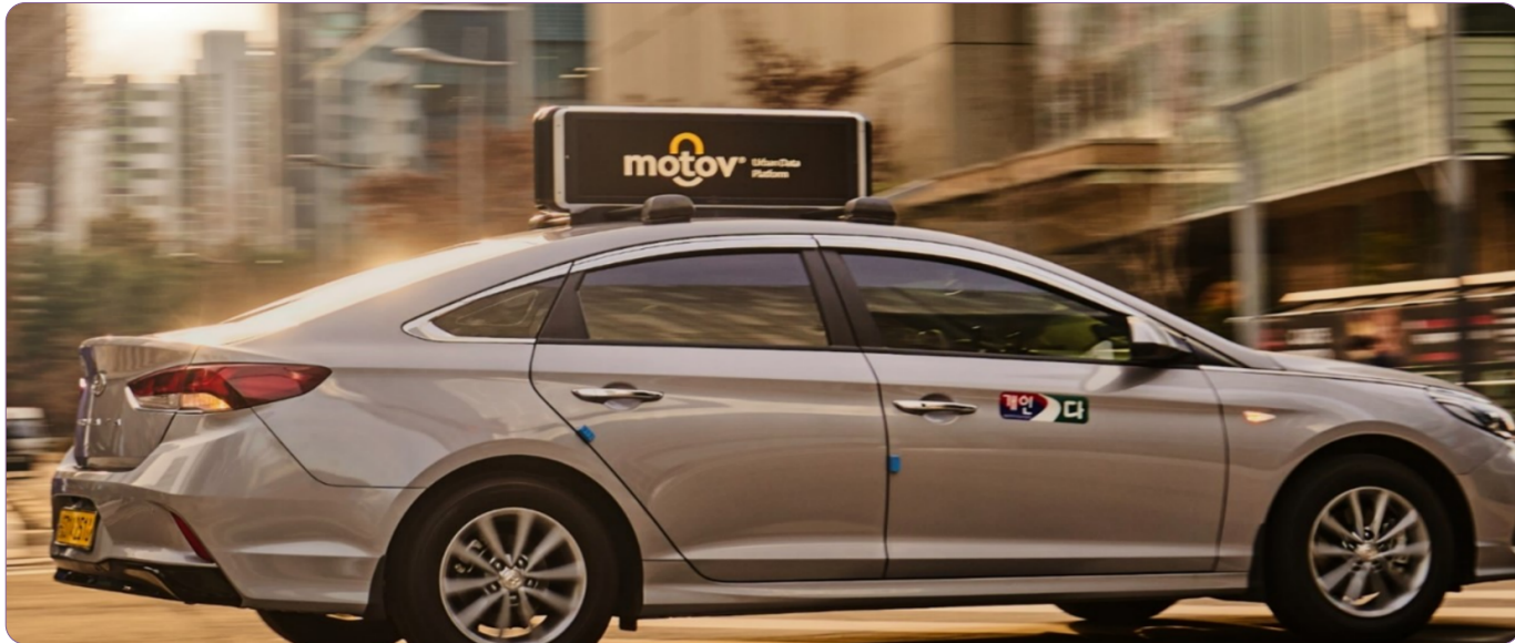
▲ 택시 지붕에 설치된 센서가 내장된 장치(미디어 보드)가 도시 데이터를 수집하고 있다.
